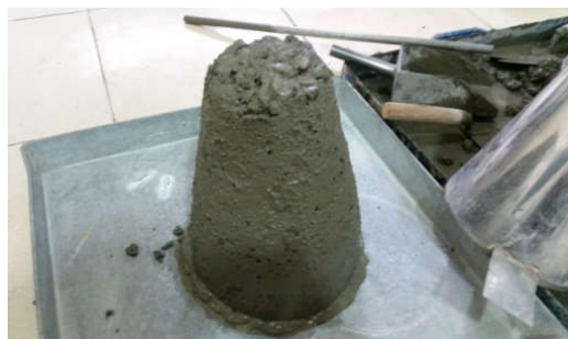
Hình 2. Độ sụt của bê tông sau khi tháo hình nón cụt
