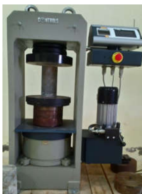
Hình 5. Thí nghiệm nén mẫu bê tông
