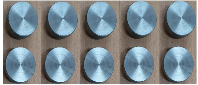
Hình 4. Mẫu thí nghiệm thép hợp kim 16Mn
