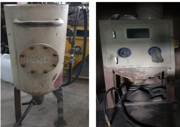
Hình 2. Máy phun hạt mài Shang-Po Moded TM-DT1
