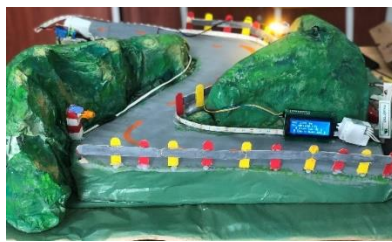
Hình 2. Sản phẩm STEAM thiết bị cảnh báo nguy hiểm ở đoạn đường khuất tầm nhìn
