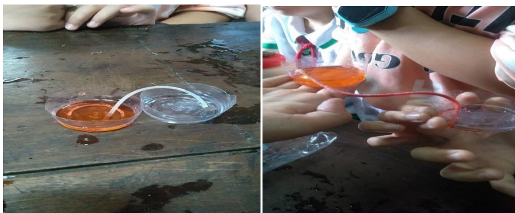
Hình 6. Thí nghiệm sự dịch chuyển của chất lỏng từ nơi cao xuống nơi thấp
