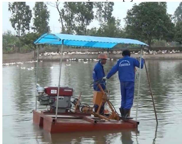
Hình 3.2 Vận hành máy hút bùn mini tự hành trên ao, hồ [3]
