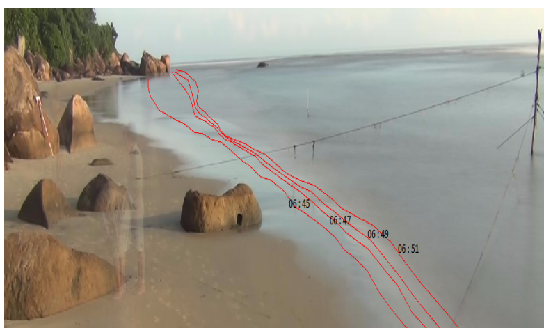
Hình 3: Ví dụ kết quả xác định địa hình sau mỗi 2 phút khi triều rút tại Cửa Dương dựa trên ảnh độ biến đổi và thể hiện đường mép nước tại các thời điểm trên ảnh phơi theo thời gian
