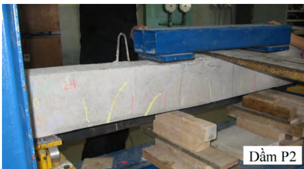
Hình 8 - Vết nứt trong vùng chịu cắt trên hai dầm P2 và P3
