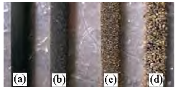
Hình 3 - Xử lý bề mặt thanh composite (a) - ban đầu; (b), (c) và (d) - thanh được bọc bởi 1, 2 và 3 lớp cát.
