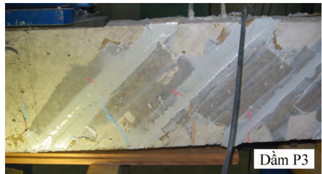
Hình 8 - Vết nứt trong vùng chịu cắt trên hai dầm P2 và P3
