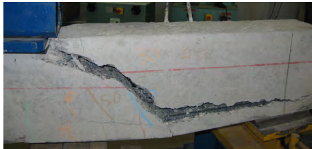
Hình 5 – Sự phá hoại do lực cắt - thí nghiệm uốn 4 điểm trên dầm P1
