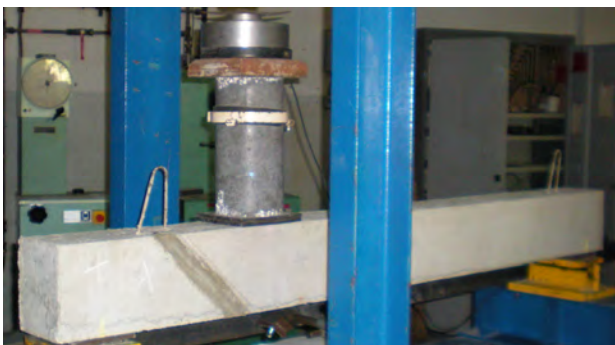
Hình 11 – Thí nghiệm uốn 3 điểm trên dầm P7
