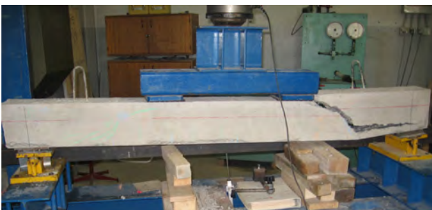
Hình 5 – Sự phá hoại do lực cắt - thí nghiệm uốn 4 điểm trên dầm P1
