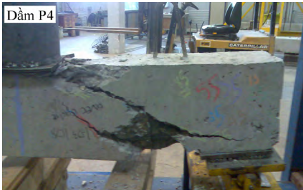
Hình 10 – Vết nứt xuất hiện trong vùng chịu lực cắt lớn trên các dầm P4 và P5
