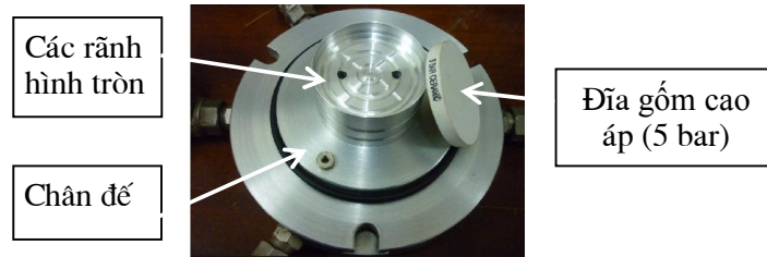
Hình 3. Ngăn chứa nước có các rãnh hình vòng tròn ở phần đầu của chân đế buồng ba trục và đĩa áp lực khí cao.
