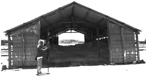
Hình 1. Xác định cao độ nền kho trữ muối khu vực Cam Ranh.
