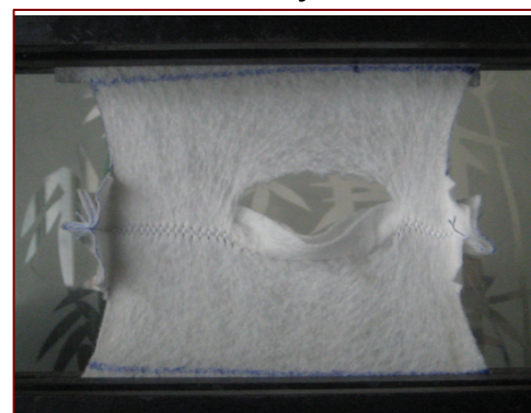
Hình 2: Thí nghiệm kéo mỗi nối: đồ thị kết quả kéo (trái), phá hoại mỗi nối (phải)
