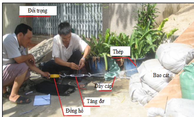
Hình 5: Thí nghiệm kéo bao cát: sơ đồ thí nghiệm (trái), kết quả thí nghiệm (phải).
