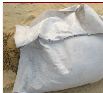
Hình 4: Các hình thức phá hoại túi trong thí nghiệm thả rơi. Bao bị biến dạng (trái), bao bị thủng (giữa), bao bị đứt dây buộc (phải)
