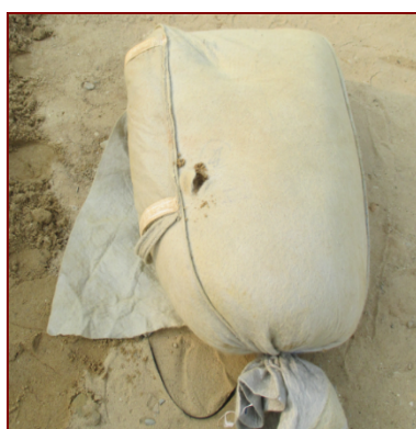
Hình 4: Các hình thức phá hoại túi trong thí nghiệm thả rơi. Bao bị biến dạng (trái), bao bị thủng (giữa), bao bị đứt dây buộc (phải)
