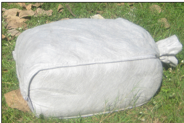
Hình 3: Bao cát sau khi được đổ đầy (trái), mái kè bằng bao cát thí điểm (phải).
