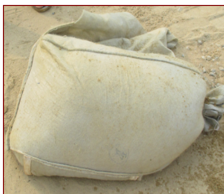
Hình 4: Các hình thức phá hoại túi trong thí nghiệm thả rơi. Bao bị biến dạng (trái), bao bị thủng (giữa), bao bị đứt dây buộc (phải)
