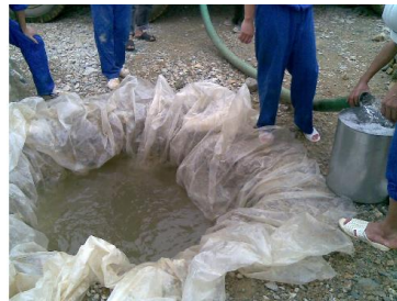
Hình 3. Đổ nước đo thể tích hố đào
