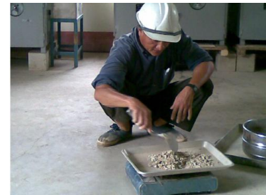
Hình 4. Thí nghiệm trong phòng xác định độ ẩm của vật liệu d < 5\text{mm}
