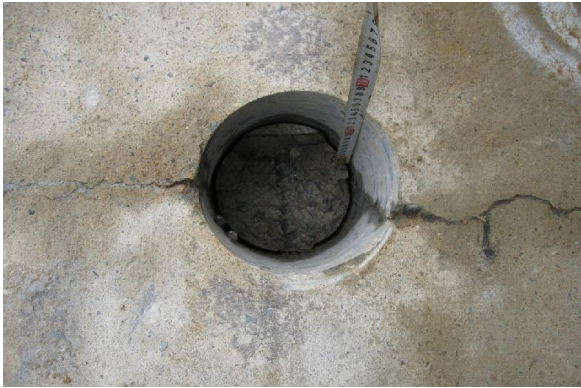
Hình 3: Kết quả kiểm tra đối chứng giữa khoan và siêu âm là trùng nhau
