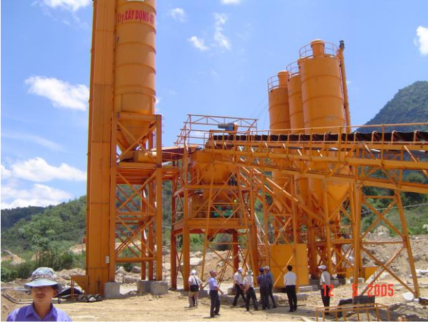
Hình 1. Xi lô trộn cấp phối bê tông BTĐL và thí nghiệm kiểm tra độ đầm chặt
