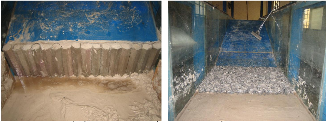
Hình 3: Kết cấu bảo vệ chân. Trái: ống buy, khi chưa lắp cát. Phải: thấm đá.
