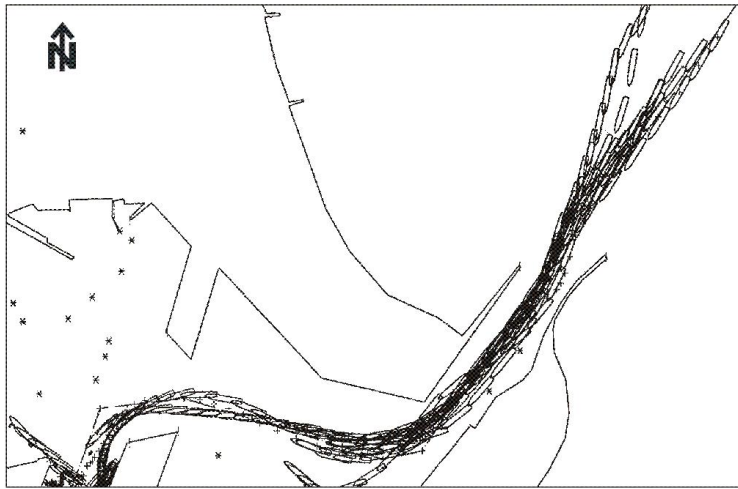
Hình 5: Vết hàng hải của tàu dưới điều kiện dòng chảy ngang mạnh (mô phỏng bằng PORTSIM)
