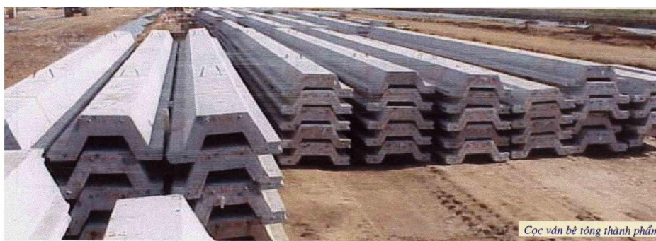
Hình 13. Cọc cừ BTCT ứng suất trước
