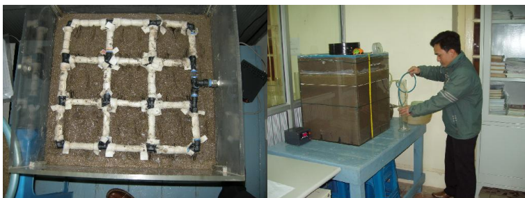
Hình 9: Lắp hệ thống tập trung nước, thiết bị đo biến dạng, áp lực và gia tải
