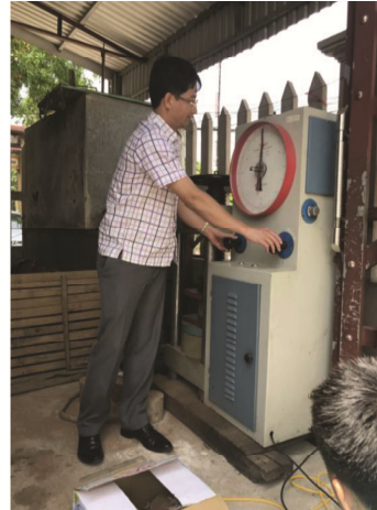
Hình 10. Thực hiện nén mẫu ở với máy nén đất tại công trường thi công đê hữu Đuống.
