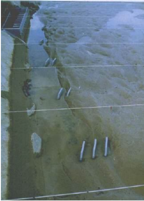
Hình 3. Rãnh xói phía trước cửa lấy nước trong mô hình thí nghiệm vật lý của Jacob Odgaard (2009)
