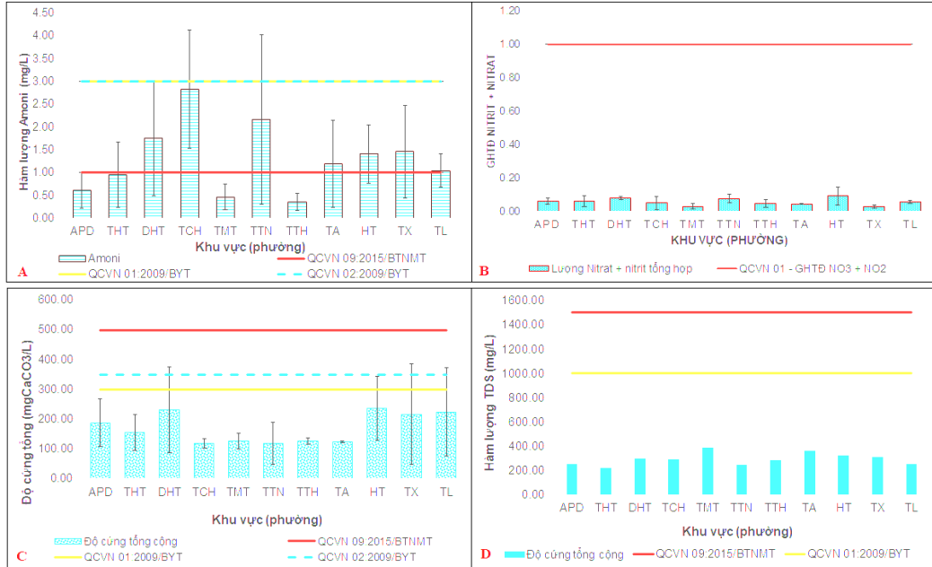
Hình 5. Kết quả đánh giá một số chỉ tiêu khác về chất lượng nước (A – Chỉ tiêu Amoni; B – GHTĐ nitrate và nitrit; C – Độ cứng tổng cộng; D – Tổng TDS)
