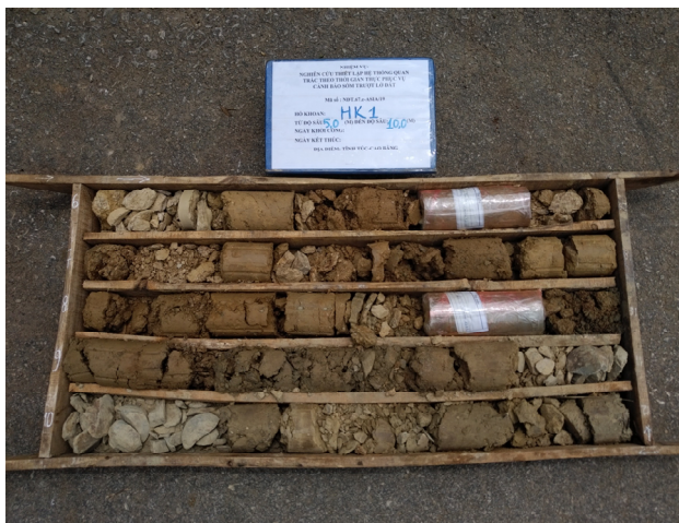
Hình 4. Lõi khoan từ độ sâu 6 m đến 10 m
