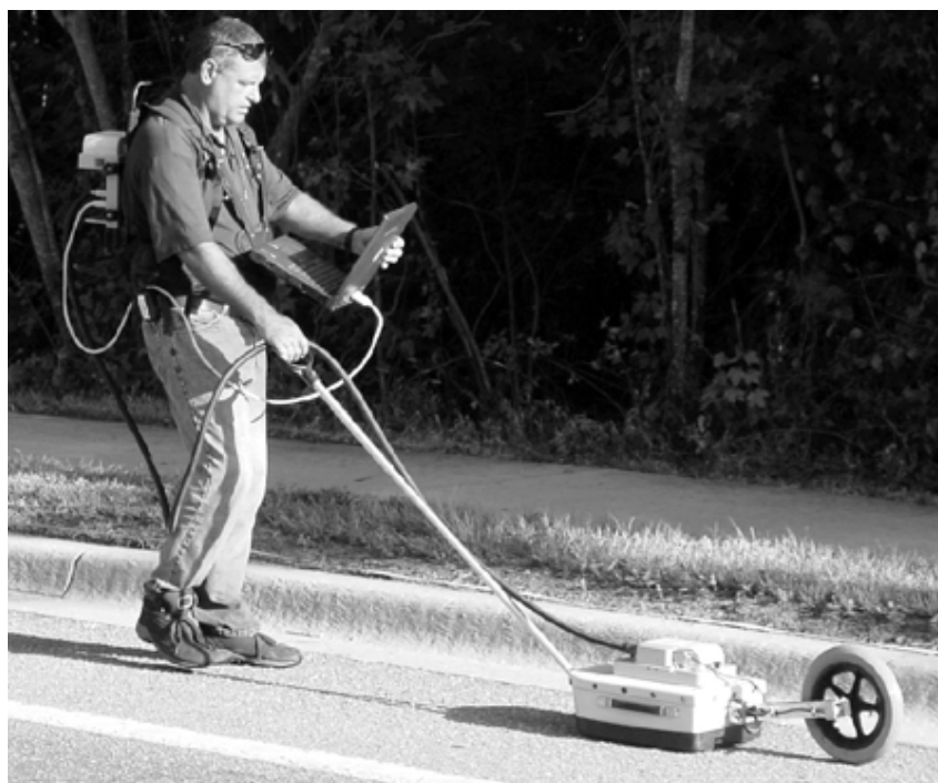
Hình 4. Quá trình quét lòng đất của thiết bị GPR và hình ảnh hiển thị
