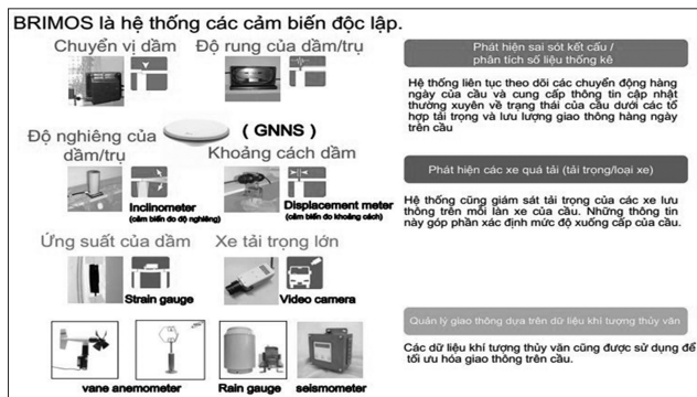
Hình 3: Hệ thống quan trắc cầu Cần Thơ (BRIMOS - Nhật)
