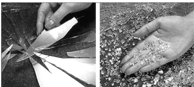
Hình 1: Sự phân mảnh khi vỡ của kính ô tô
