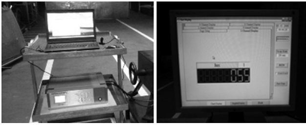
Hình 9: Thiết bị điều chỉnh góc quay đèn và kết quả đo độ rọi
