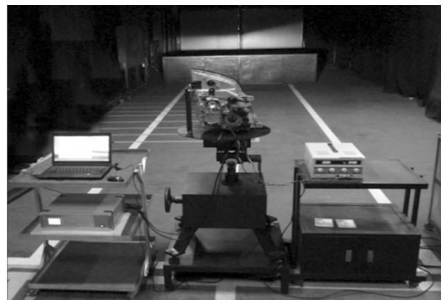
Hình 1: Hệ thống thiết bị thử tính ổn định đặc tính quang học và màu sắc ánh sáng đèn chiếu sáng phía trước
