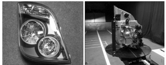
Hình 6: Chuẩn bị mẫu và gá đặt mẫu lên thiết bị
