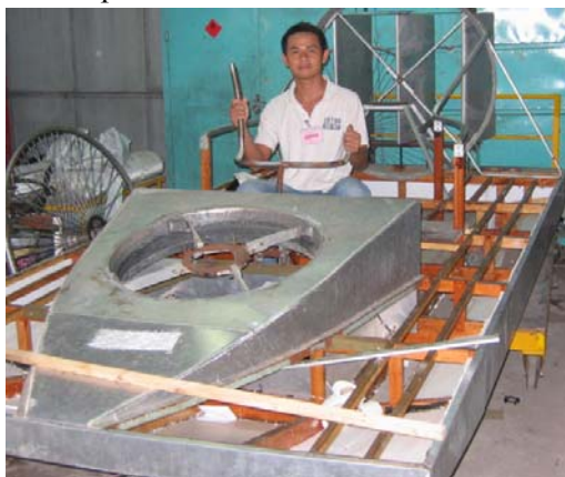
Hình 2. Tàu đệm khí 2 chỗ ngồi đang được đóng theo mẫu tại công ty Triệu Phước.
