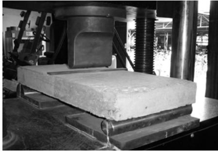
Hình 3. Thí nghiệm uốn bản 70x300x650
