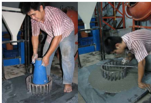
Hình 11. Thí nghiệm J-Ring cho cấp phối tối ưu, sử dụng vòng J-Ring có 22 thanh chắn (đặc trưng cho mật độ cốt thép cao nhất)
