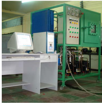
Hình 2. Hệ thống STH DS-3 tự lạnh đông (-50 ÷ -45) 0 C
