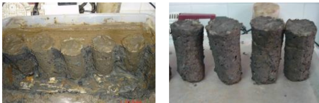
Hình 2. Mẫu đất thí nghiệm sau khi lấy ra khỏi thùng bảo dưỡng.
