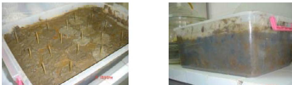
Hình 1. Bảo dưỡng mẫu thí nghiệm sau khi trộn đất với vôi và xi măng
