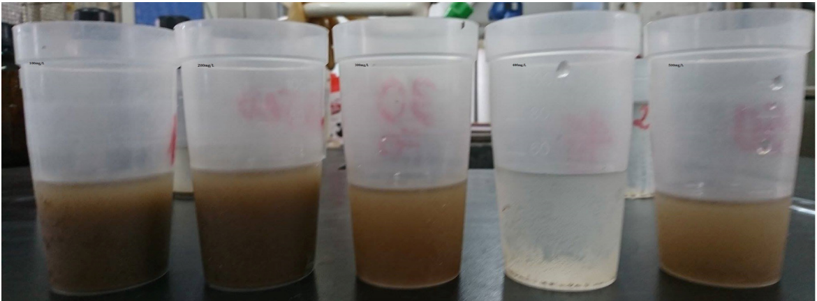
Hình 6. Nước tách khỏi bùn bằng FLOPAM FO 4240SH (hàm lượng 100 - 500 mg/L)
