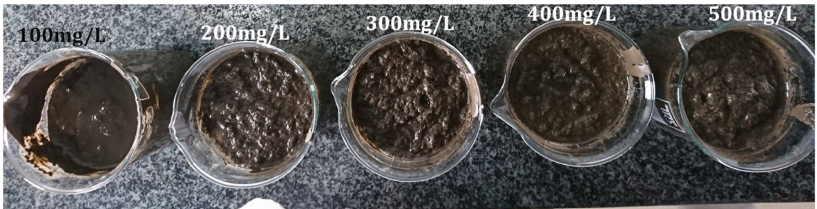
Hình 3. Mẫu bùn được keo tụ tạo bông với polymer KP206BH2 (hàm lượng 100-500 mg/L)
