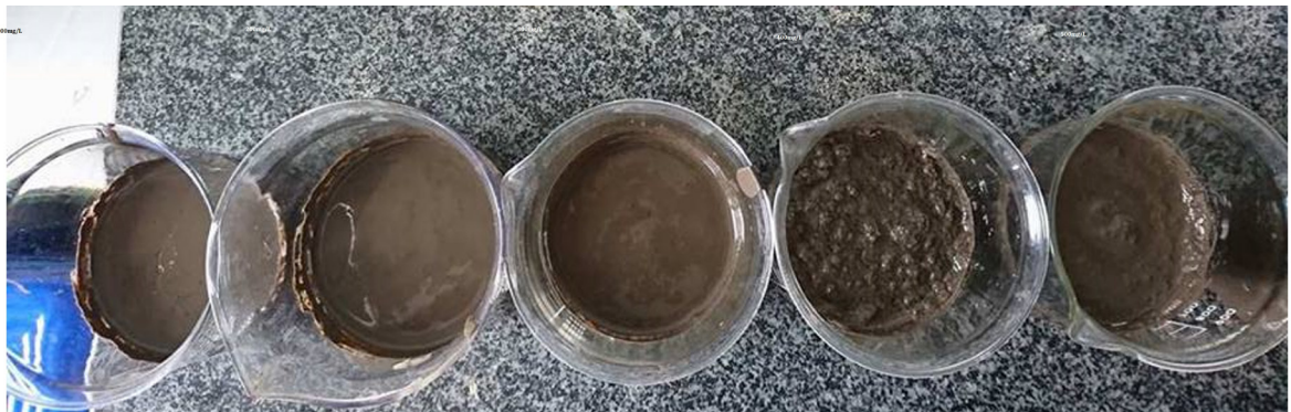
Hình 4. Mẫu bùn được keo tụ tạo bông với polymer FLOPAM FO 4240SH (hàm lượng 100 - 500 mg/L)
