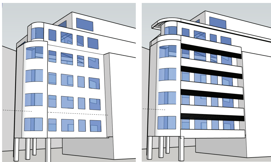
a. Mô hình cơ sở - A (không có KCCN) b. Mô hình hiện trạng - B (Có KCCN) Hình 2. Mô hình tòa nhà khi có và không có kết cấu che nắng (Nguồn: tác giả)
