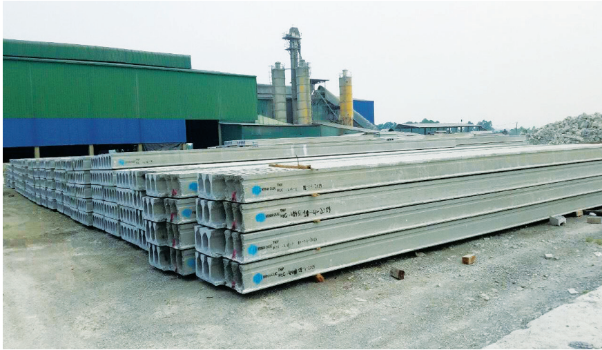
Cát nhân tạo sử dụng trong các cấu kiện bê tông của nhà máy Minh Đức thuộc Tổng công ty Sơn Trường (Hải Phòng)
