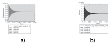
Hình 12. Chuyển vị và ứng suất của tấm BTCT gia cường 2 lớp lưới
