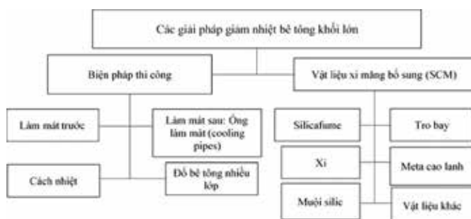
Hình 1. Các giải pháp giảm nhiệt cho bê tông khối lớn [2]
