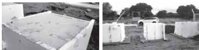
Hình 2. Mẫu đo nhiệt độ tâm khối bê tông, kích thước mẫu 1,6m x 1,6m x 1,6m.
