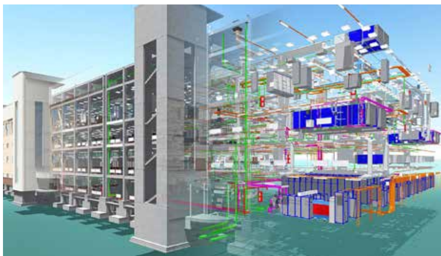
Công nghệ BIM có thể mô phỏng quá trình xây dựng để dự đoán các vấn đề tiềm ẩn và đưa ra biện pháp phòng ngừa trước
