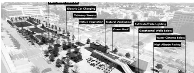
Hình 5. Canal Park (Washington D.C., Hoa Kỳ) Cải tạo bến xe buýt cũ thành công viên xanh tái sử dụng nước mưa với hệ thống vườn mưa và hồ chứa ngầm (Nguồn: OLIN Studio, 2012)
