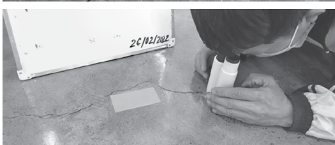
Nhà xưởng KCN Châu Sơn Hà Nam Khảo sát hiện trạng nứt nền nhà xưởng
