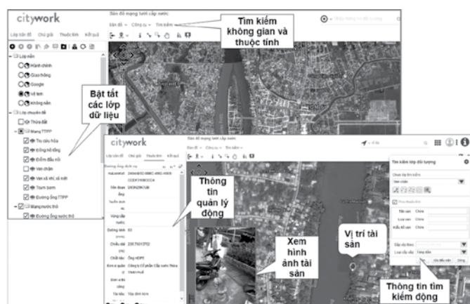
Hình 2. Ứng dụng công nghệ bản đồ số trong quản lý, bảo trì tài sản mạng lưới cấp nước
