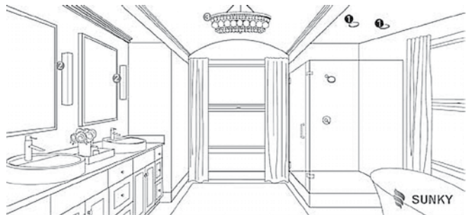
Hình 7: Các vị trí cần lắp đặt đèn chiếu sáng trong phòng tắm
