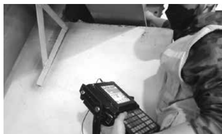
Kiểm tra siêu âm mối hàn kết cấu thép
