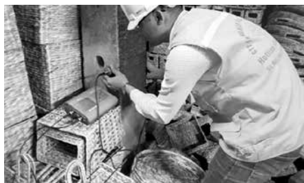
Kiểm tra chất lượng bê tông PP siêu âm
