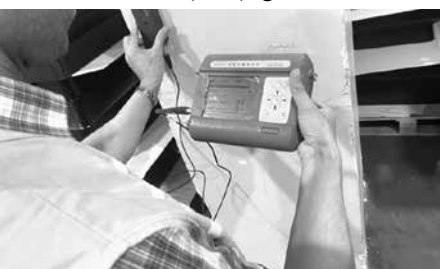
Khoan kiểm tra lớp bảo vệ thép sàn
