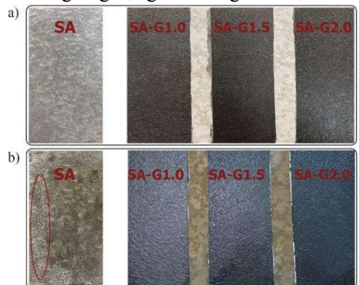
Hình 9 (a) màng nhựa SA và composite SA-G trước khi ngâm NaOH (5%), màng nhựa SA và composite SA-G sau 144 h ngâm NaOH (5%),
