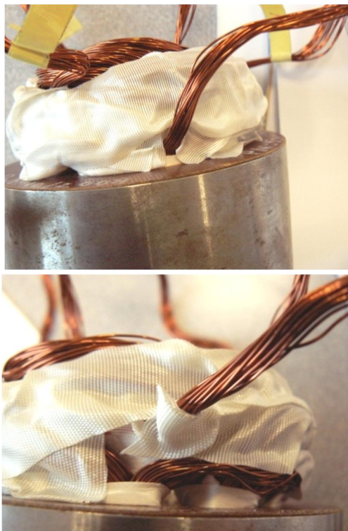
Hình 7. Đầu vào và đầu ra của một pha có tiếp xúc với pha khác: không có tiếp xúc nhìn thấy được với phần trung gian (stator loại A không đai dây và không có sơn cách điện)
