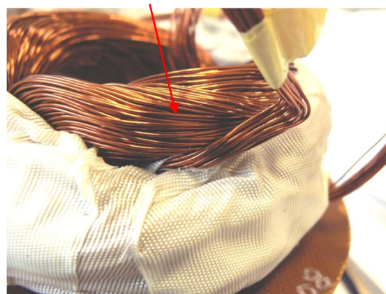
Hình 6. Tiếp xúc giữa đầu ra của pha - phần trung gian (stator loại A không đai dây và không có sơn cách điện)
