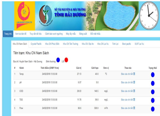
Hình 6. Minh họa kết quả truyền và nhận dữ liệu từ các trạm quan trắc tự động nước thải
