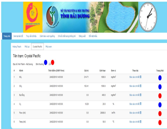
Hình 7. Minh họa kết quả truyền và nhận dữ liệu từ các trạm quan trắc khí thải
