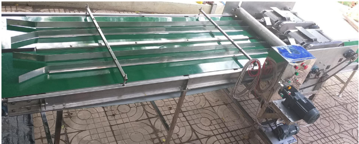
Hình 10. Thiết kế và chế tạo máy tách vỏ và thái hạt lá nha đam
