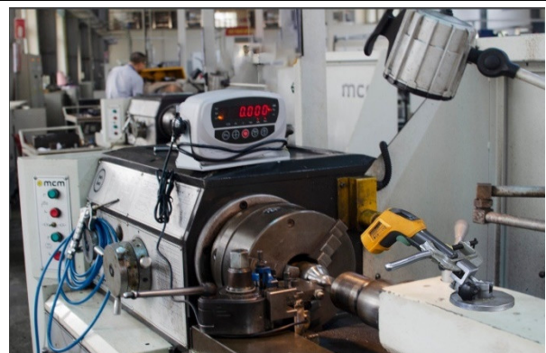
Hình 8. Sơ đồ gá đặt dụng cụ đo lực và đo nhiệt khi thực nghiệm tiện định hình
