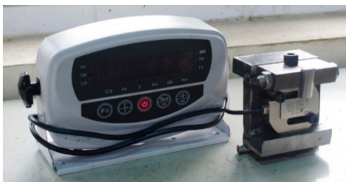
Hình 7. Đồng hồ đo lực và dao tiện định hình gá đặt cùng bộ gá và loadcell
