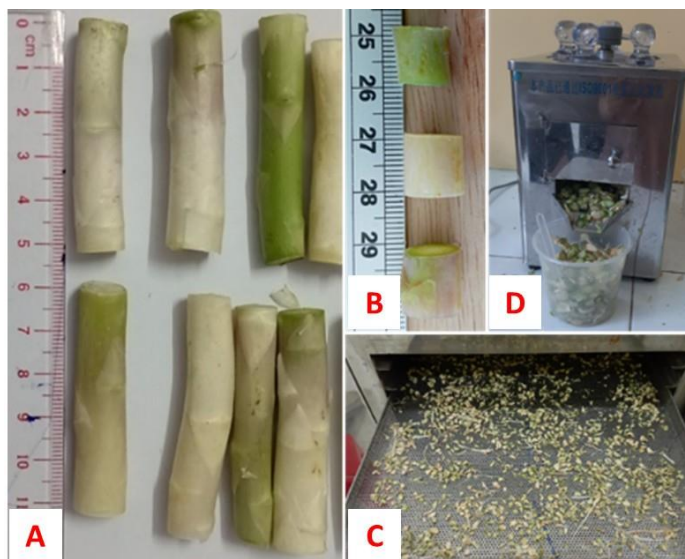
Hình 1. Kích thước gốc măng tây khác nhau; A. Kích thước 50 mm, B. Kích thước 10 mm, C. Kích thước 2 mm, D. Máy cắt được liệu
