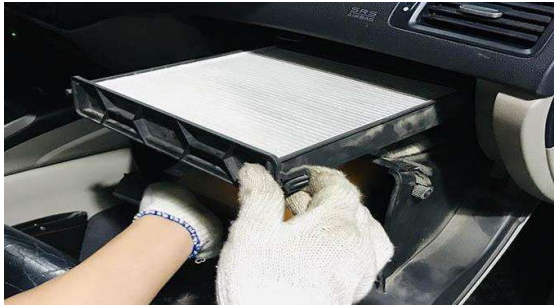
Hình 1. Tấm lọc gió điều hòa lắp trong xe ô tô
