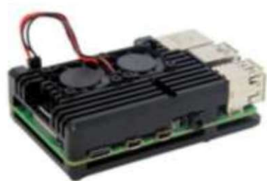
Hình 4. Raspberry Pi 4 sau khi đã trang bị hệ thống tản nhiệt
