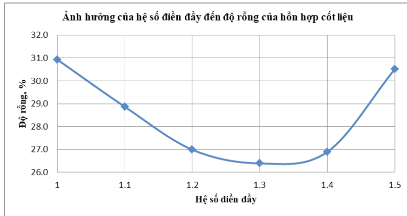
Hình 3. Đồ thị biểu diễn ảnh hưởng của hệ số điền đầy đến độ rỗng hỗn hợp cốt liệu
